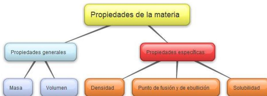
Ejemplo: la masa es una propiedad general, y no permite diferenciar sustancias: se pueden tener 5 Kg de hierro y 5Kg de hielo. La densidad es una propiedad específica, permite diferenciar sustancias: la densidad del aluminio es  $2,7 \text{ gr/cm}^3$ , mientras que la densidad del mercurio es de  $13 \text{ gr/cm}^3$ .
