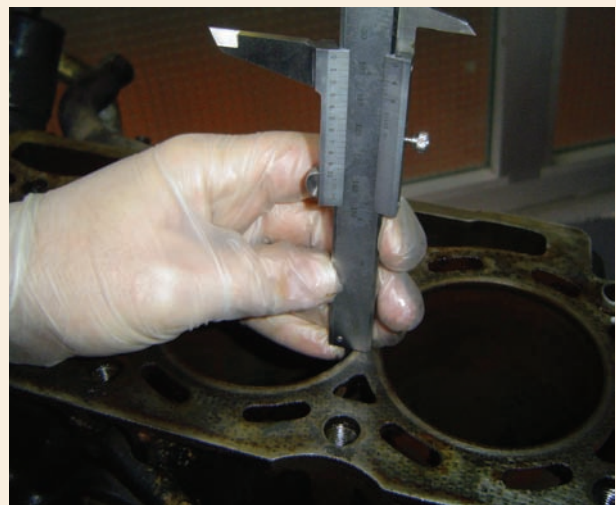
↑ Figura 1.27. Medida de la carrera del cilindro.
