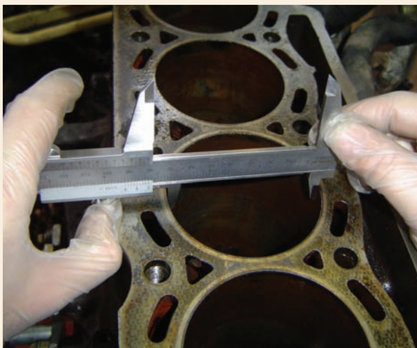
↑ Figura 1.26. Medida del diámetro de un cilindro.
