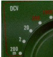
El latiguillo negro se pone en el COM y el rojo en la posición V. El selector se sitúa en la posición adecuada según sea el valor del voltaje a medir: DCV (continua), o ACV (alterna).
