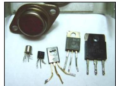
Se puede utilizar como amplificador o como interruptor controlado por una pequeña corriente de base. Es un elemento básico en los circuitos electrónicos.
