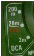
El latiguillo negro se pone en el COM y el rojo en la posición A ó 10A, el selector se sitúa en la posición adecuada según sea el valor de la intensidad a medir: DCA (continua), o ACA (alterna).
