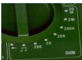
El latiguillo negro se pone en el COM y el rojo en la posición  $\Omega$  ó OHM, el selector se sitúa en la posición adecuada según el valor de la resistencia.
